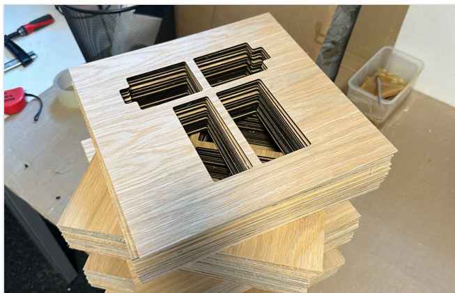
LASER CUT Laserem řezaná překližka, sériová výroba
