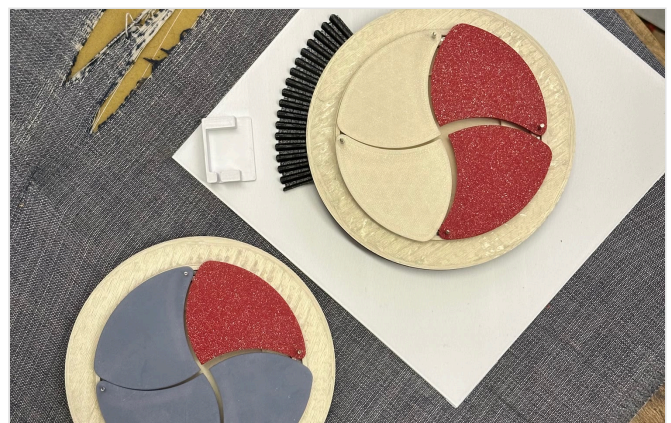
PROTOTYPE 3D tištěné prototypy irisu
